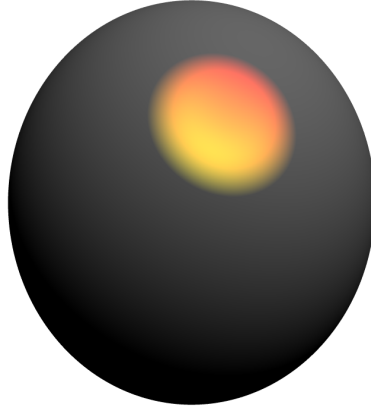
FIG. 2.17 – Exemple de gradient de couleur obtenu en spécifiant une couleur du lobe jaune pour la configuration (\theta_i, \phi_i) = (0, 0) et une couleur rouge pour la configuration (\theta_i, \phi_i) = (\frac{\pi}{2}, 0) .
